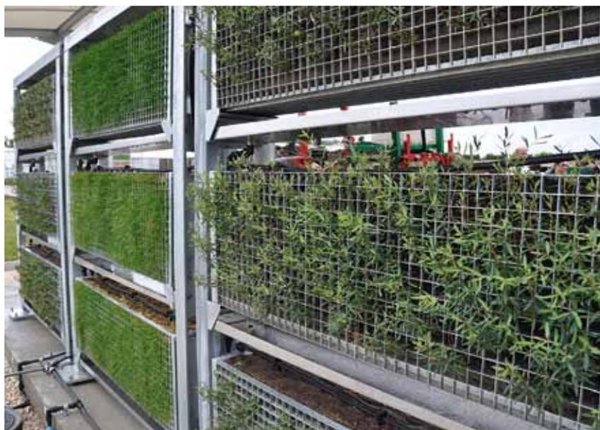
Les différentes essences en place actuellement sont en phase d'essai (de gauche à droite: bambous, gazon, saule).
