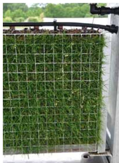
Vue d'un module du système «VG-Biobed» avec l'eau excédentaire récupérée qui retourne pour un nouveau cycle dans la cuve enterrée.
