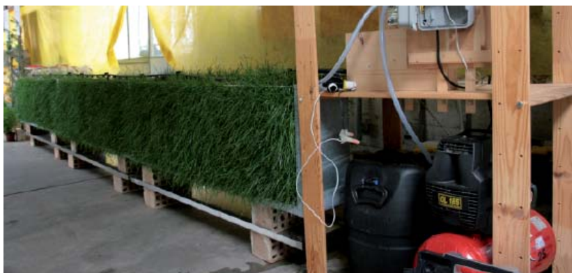
Das System «VG-Biobed™» verbraucht im Gegensatz zu anderen Aufbereitungsanlagen keine Erde, sondern produziert Biomasse, ist platzsparend, und kann zur Isolation von Gebäuden beitragen.
